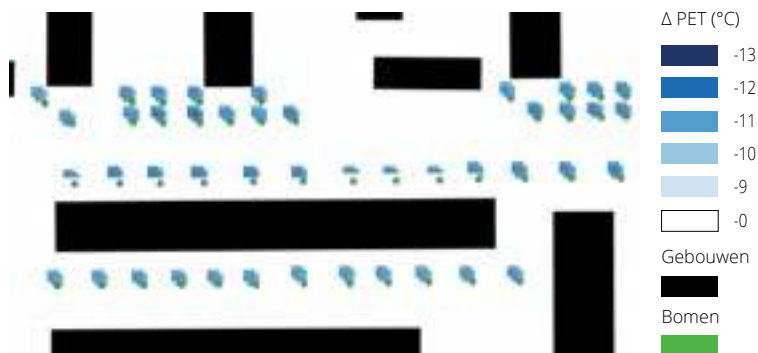
Figuur 3.11 Het verkoelende effect van kleine bomen in een van oost naar west georiënteerde straat op de gevoelstemperatuur (PET, °C).
