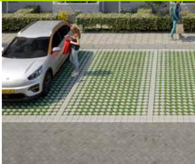
Toepassingen met verschillende Gradiënt-tegels: links de ovale (65% groen) met loopgedeelte van gesloten tegels (5% open voor infiltratie); rechts de ovale, vierkante (33% groen) en gesloten tegels. Beeld: Studio Buil
